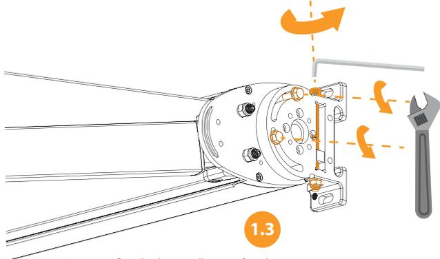
Una vez aflojados los tornillos que fijan la inclinación en ambos lados, gire la pieza lateral hasta conseguir la inclinación deseada para realizar la instalación al techo. Realice esta operación apretando o aflojando el tornillo con cabeza allen.
