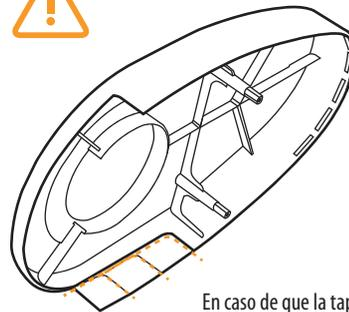
En caso de que la tapa embellecedora no encaje correctamente debido a la nueva inclinación, dispone de hendiduras que puede cortar para acomodar la pieza correctamente.
