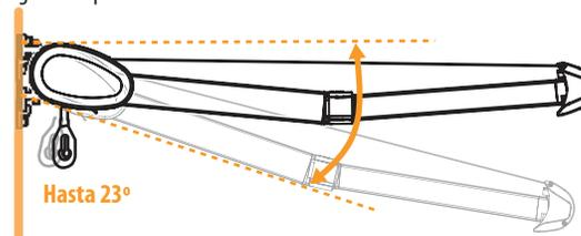
**!** El Ajuste de inclinación a de realizarse con el toldo extendido. Este paso se realiza de igual forma en la instalación a pared y en la instalación a techo.
