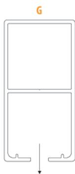
El hueco de la guía tiene que ir orientado hacia abajo.
